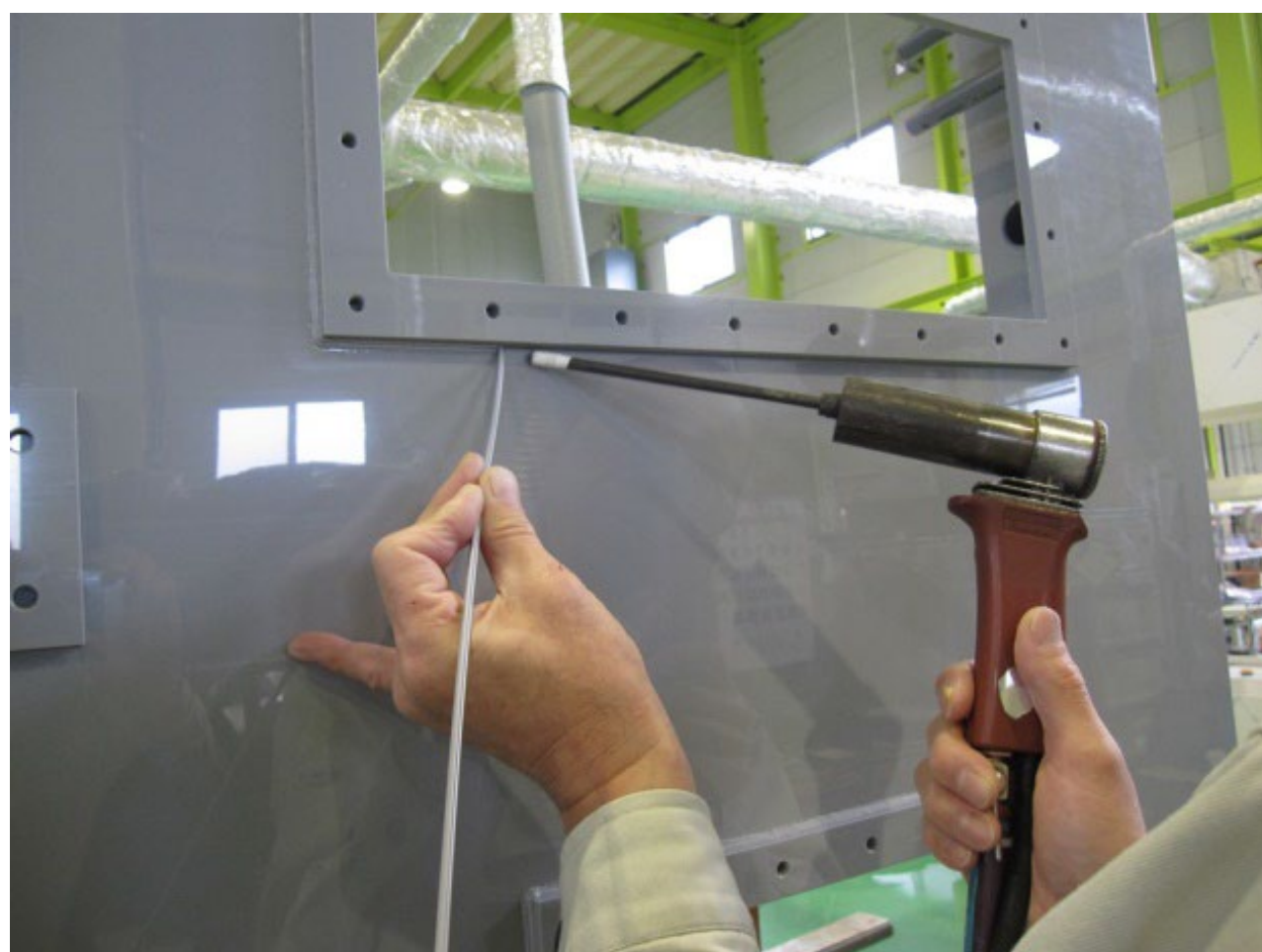
熱風による、樹脂溶接作業(PVC)
