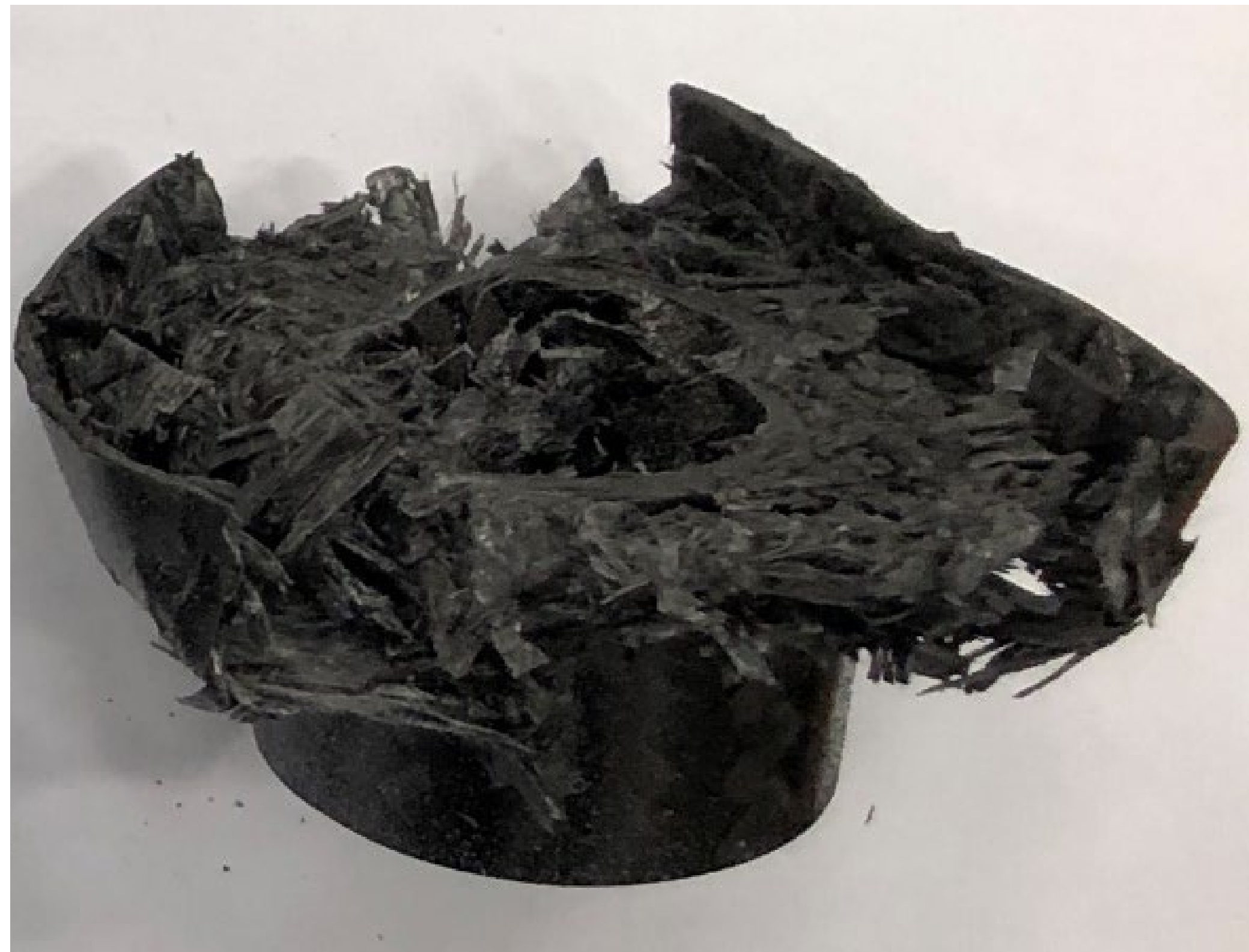
圧縮試験結果(CFRP)(ナイフエッジ有)
