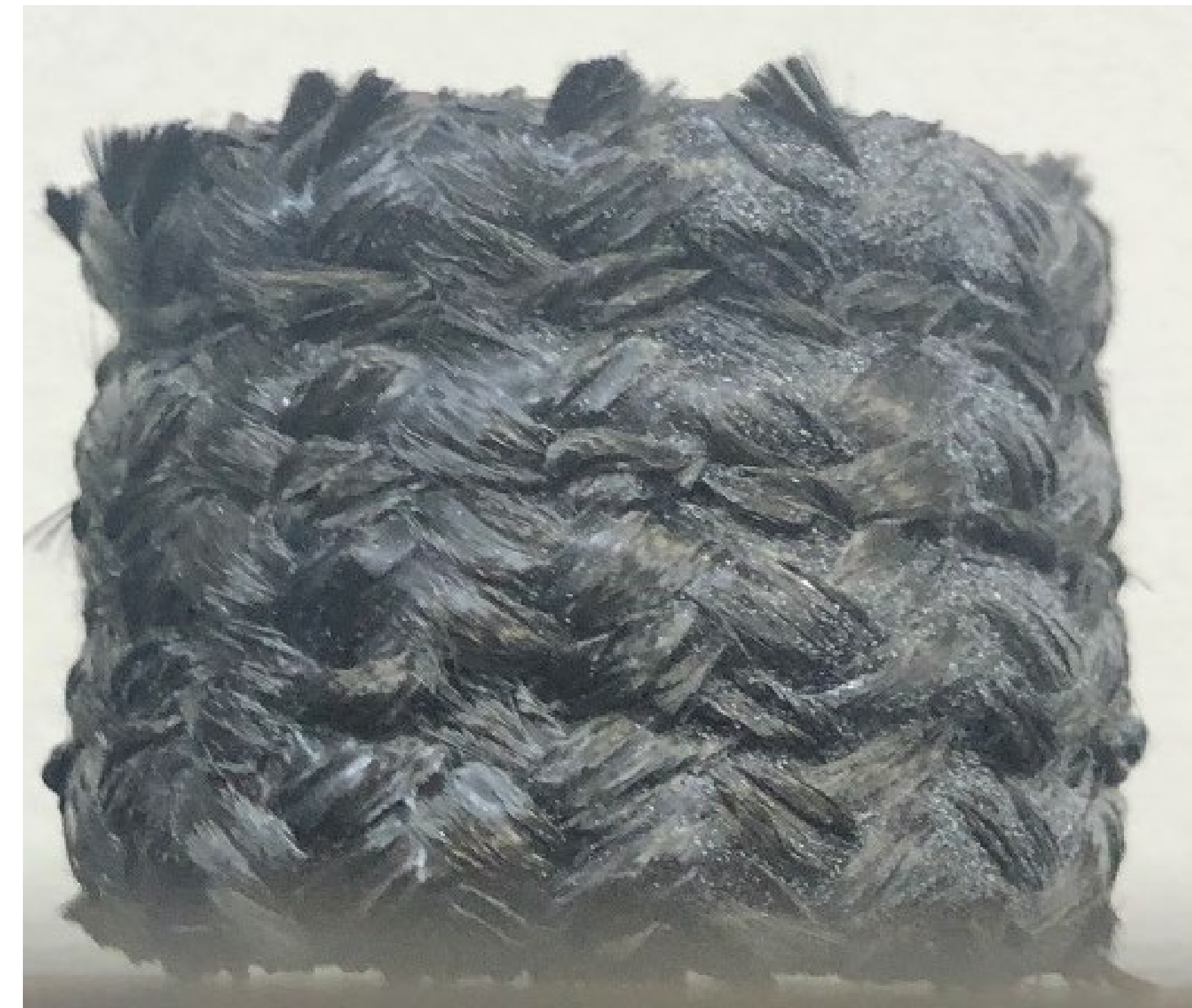
圧縮試験結果(CFRP)(ナイフエッジ無)
