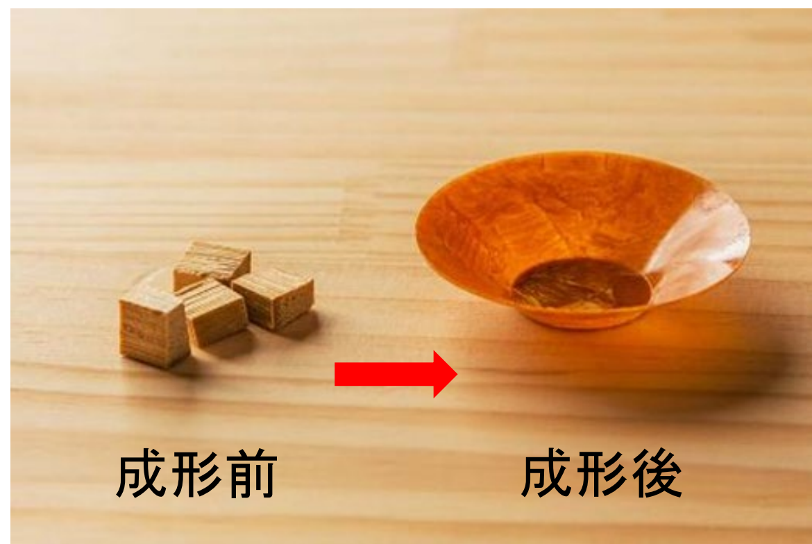
タケ材から流動成形で作られたスピーカーコーン
