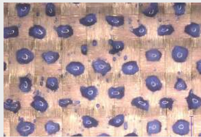
ガラスクロスDot®のマイクロスコープ画像 紫色が熱可塑性樹脂のドット (撮影のために樹脂を染めている)
