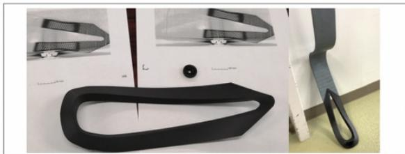
カーボン3Dプリンタで製作した空力部品
