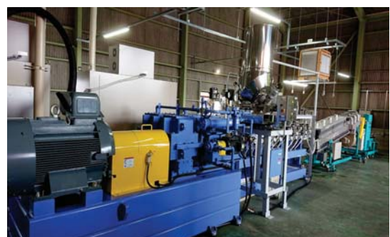
写真2 2軸押し出し設備(100 t/月)
