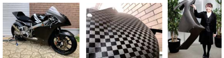
軽いドライカーボンCFRPカウルをさらに-30~40%の軽量化かつ曲げ剛性2.5倍を実現
