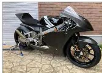
軽いドライカーボンCFRPカウルをさらに-30~40%の軽量化かつ曲げ剛性2.5倍を実現
